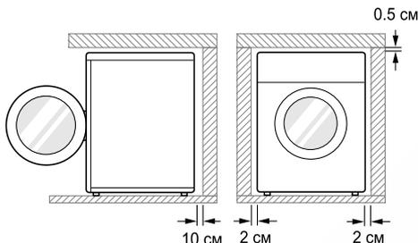
**Ровный пол:** допустимый уклон пола под всей занимаемой машиной площадью не должен превышать 1°.
