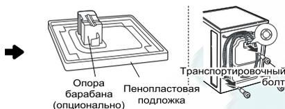
Снимите транспортировочные болты и опоры.
